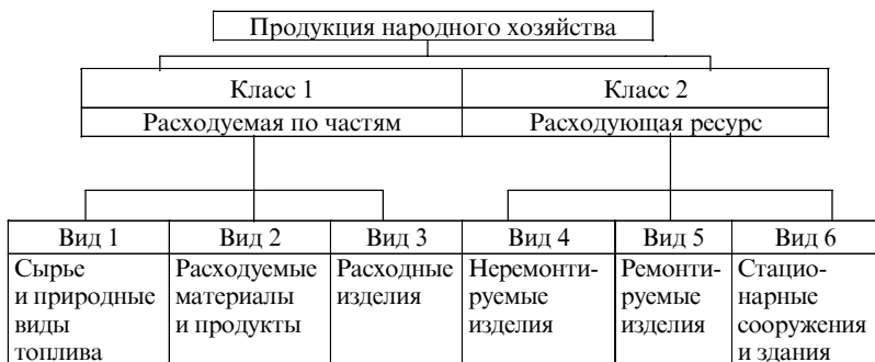
Рис. 3. Классификация продукции народного хозяйства по признаку расхода по частям или расхода ресурса
